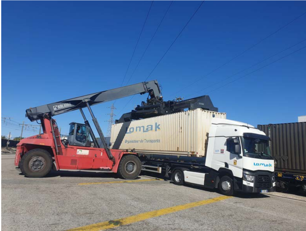
Figure 1: Transbordement d'une des caisses mobiles au terminal en Courtine (crédit photo @AF&C)
